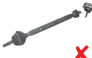
Wał jest niekompletny — przegub jest odłamany.
