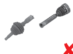
Wał profilowy jest uszkodzony.
