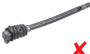
Wał jest niekompletny — brakuje przegubu.
